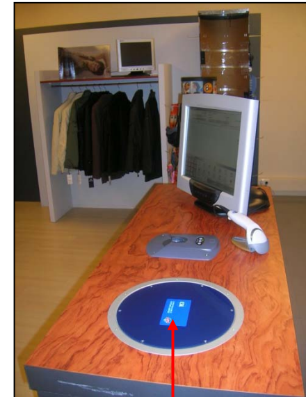
Sistema de lectura masiva del producto (TAG RFID)
